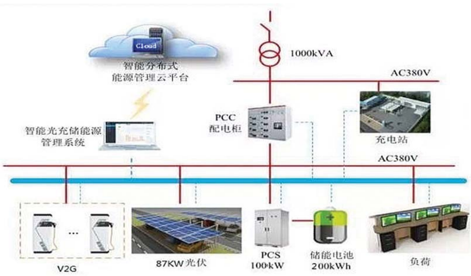
光充储一体充电站用户侧能源互联网系统
